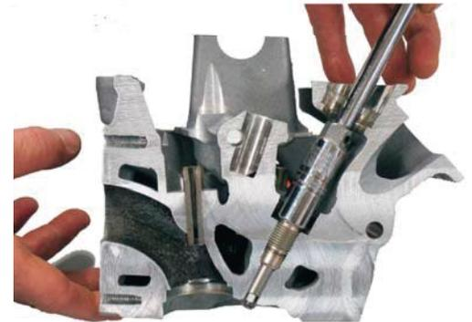
**ADVERTENCIA:** El uso excesivo de limpia carburador en la camara de combustión podría causar hidro-bloqueo del motor o causar daño interno, remueva todo el líquido posible.
